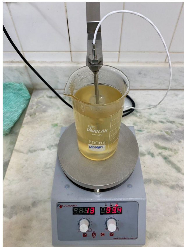
Figura 1 – Procedimento de desnaturação do bioensumo por meio da fervura em agitador com aquecimento.
