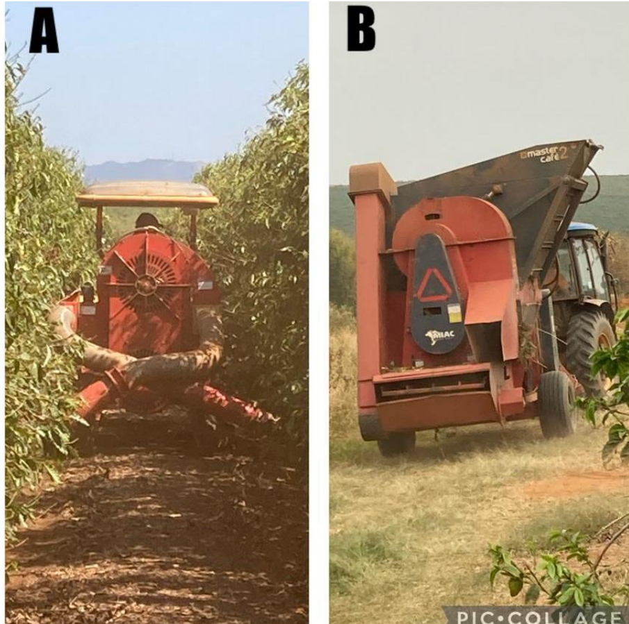
Figura 26 - Máquinas alugadas pela empresa para fazenda localizada em Nepomuceno - MG. A- arruador; B- recolhedora de café.
