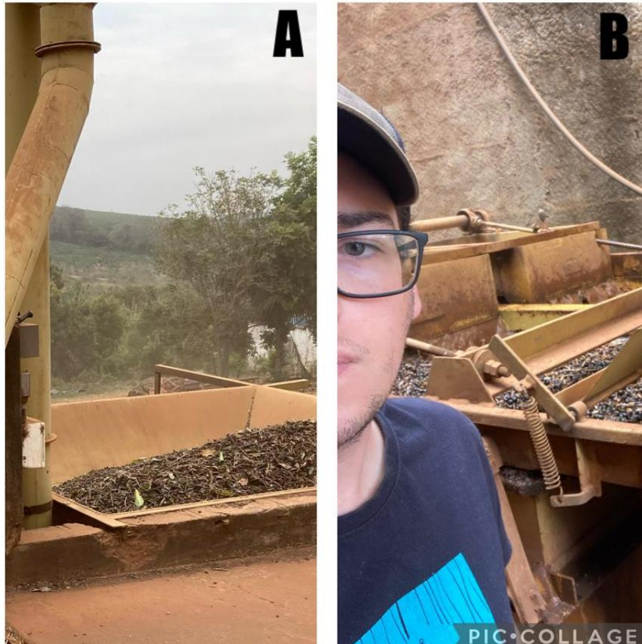
Figura 28 – Estruturas de pós colheita do café. A – moega de recebimento; B- lavador de café.
