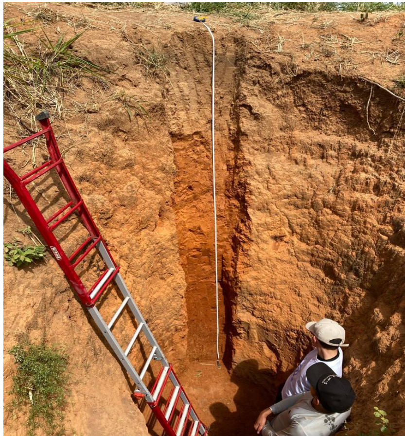
Figura 1. Perfil de Argissolo Vermelho-Amarelo, Horizonte B Textural sobre Horizonte Plíntico. IFCE, Iguatu-CE
