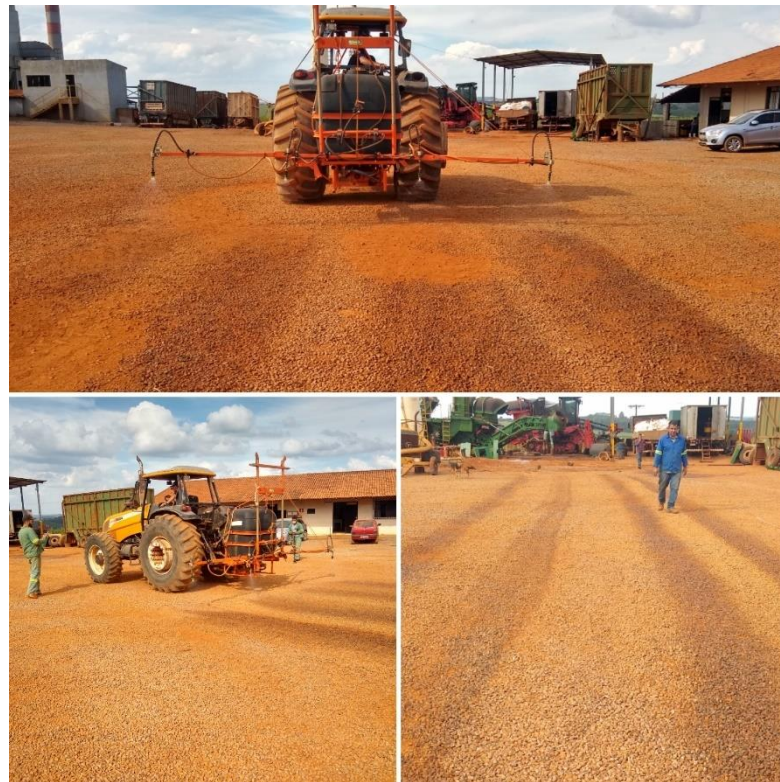
Figura 6 – Avaliações e regulagem do pulverizador acoplado no trator
