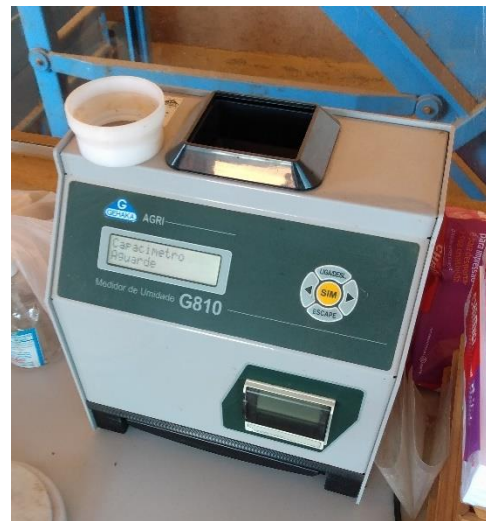
Fonte: o Autor Figura 9: Medidor de umidade de grãos G810.
