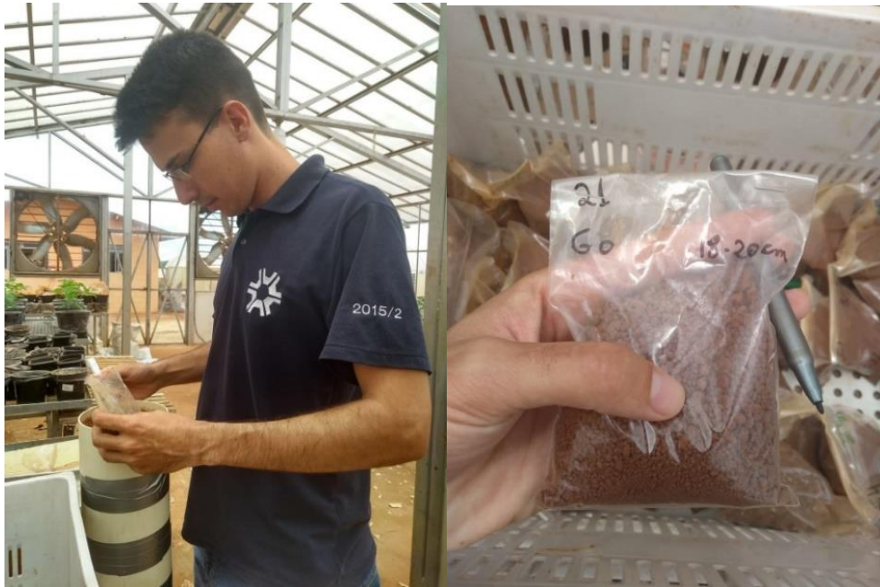
Figura 4: Amostragem para análise química e de condutividade elétrica (CE).
