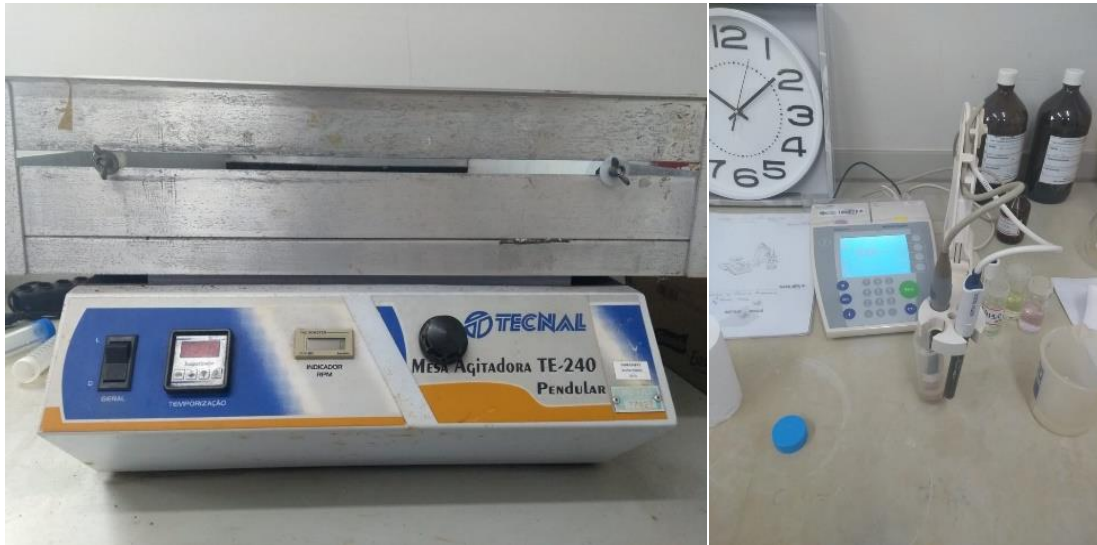
Figura 6: Mesa agitadora e condutivimetro Mettler
