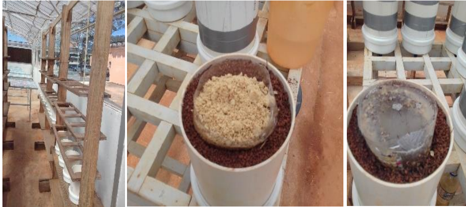
Figura 3: Montagem das colunas, aplicação das doses de gesso e condução do experimento.
