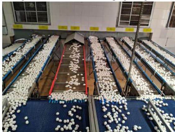
Figura 18 - Esteira transportadora de ovos dos galpões para a sala de classificação.
