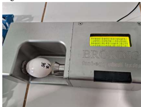
Figura 29 - Análise se resistência de casca.
