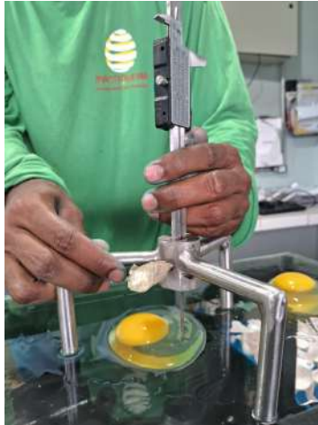
Figura 30 - Uso do paquímetro para determinar altura de albúmen.
