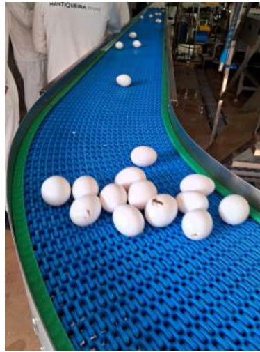
Figura 19 - Esteira de retorno dos ovos para higienização.
