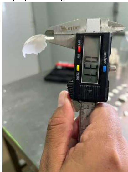
Figura 33 - Uso do paquímetro para análise de espessura de casca.
