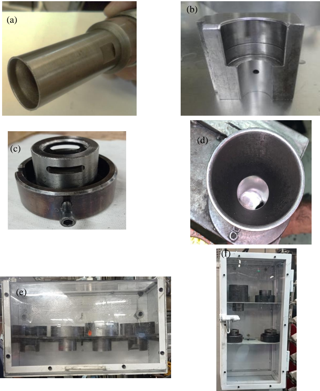
Figura 14 - Condições conformes dos ferramentais e locais de trabalho encontrados no processo de montagem: (a) injetor de nitrogênio, (b) apoio do conjunto do pistão, (c) apoio do conjunto de válvula, (d) apoio da haste montada e (e) ferramentais organizados.
