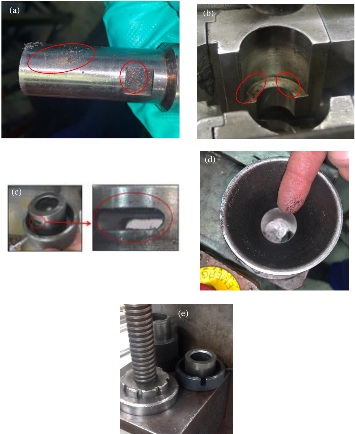
Figura 12 - Condições não conformes dos ferramentais e locais de trabalho encontrados no processo de montagem: (a) injetor de nitrogênio, (b) apoio do conjunto do pistão, (c) apoio do conjunto de válvula, (d) apoio da haste montada, (e) ferramentais desorganizados.
