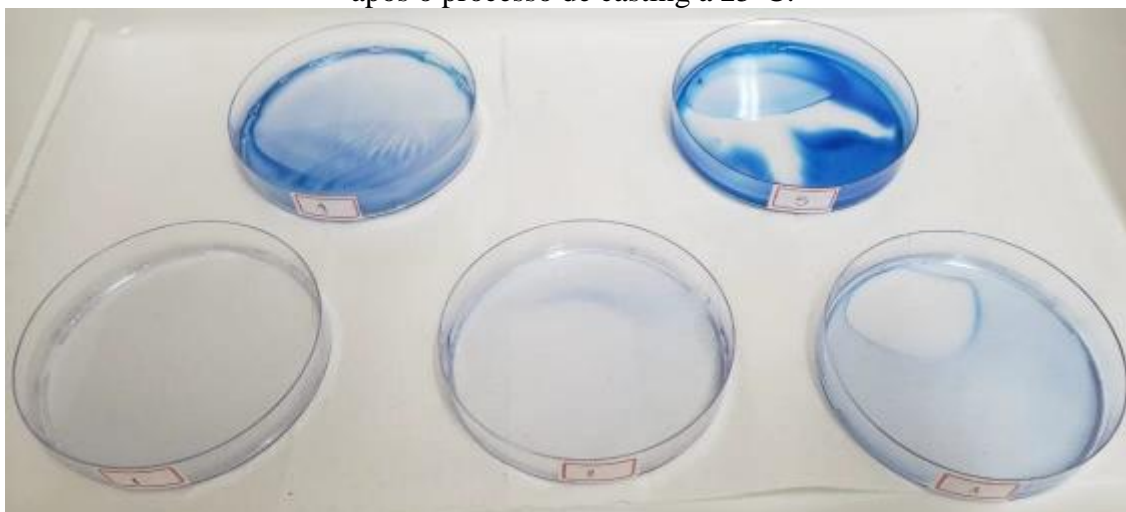
Figura 3 - Avaliação inicial da concentração do corante MG: 5,453 \times 10^{-5} , 1,09 \times 10^{-4} , 2,18 \times 10^{-4} , 5,45 \times 10^{-4} , 1,09 \times 10^{-3} \text{ molL}^{-1} , respectivamente, nos filmes com P1 e C16 após o processo de casting a 25^\circ\text{C} .
