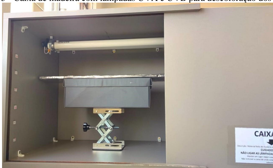
Figura 5 - Caixa de madeira com lâmpadas UVA e UVB para descoloração dos filmes.
