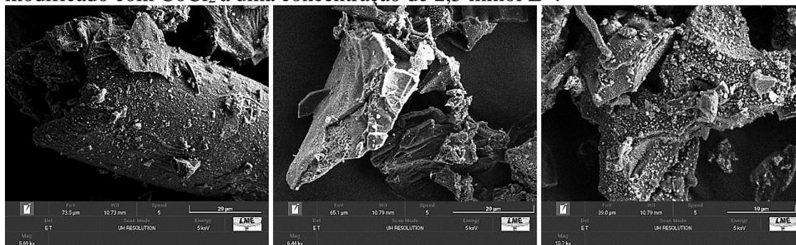
Figura 12. Microestrutura do biocarvão produzido a partir de biomassa de palha de milho modificado com  $\text{NiCl}_2$  a uma concentração de  $2,5 \text{ mmol L}^{-1}$ .
