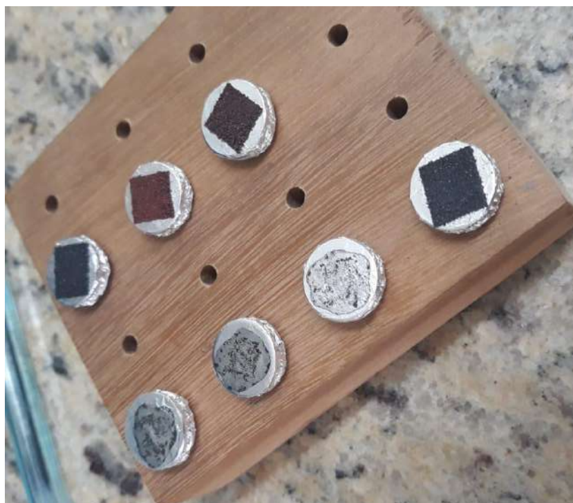
Figura 8 - Amostras no porta-amostra com fita de carbono dupla
