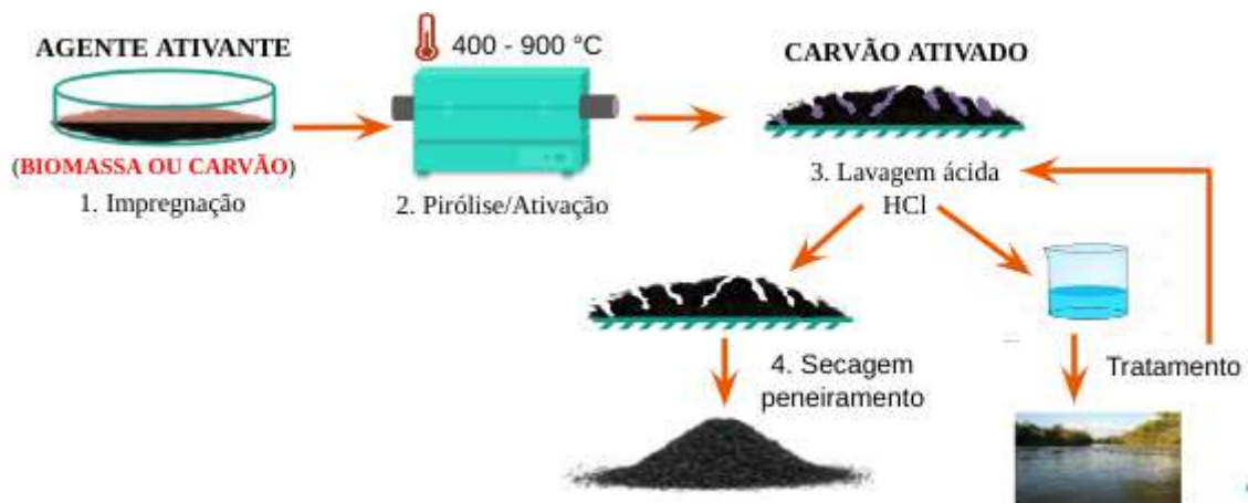
Figura 2 - Esquemática do processo de ativação química.
