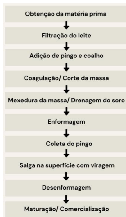
Figura 2 - Fluxograma de elaboração de queijo artesanal Mantiqueira de Minas.
