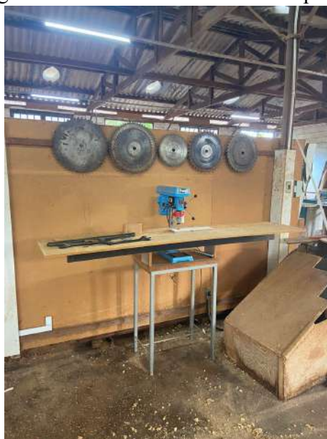
Figura 9: Furadeira de Bancada adaptada.
