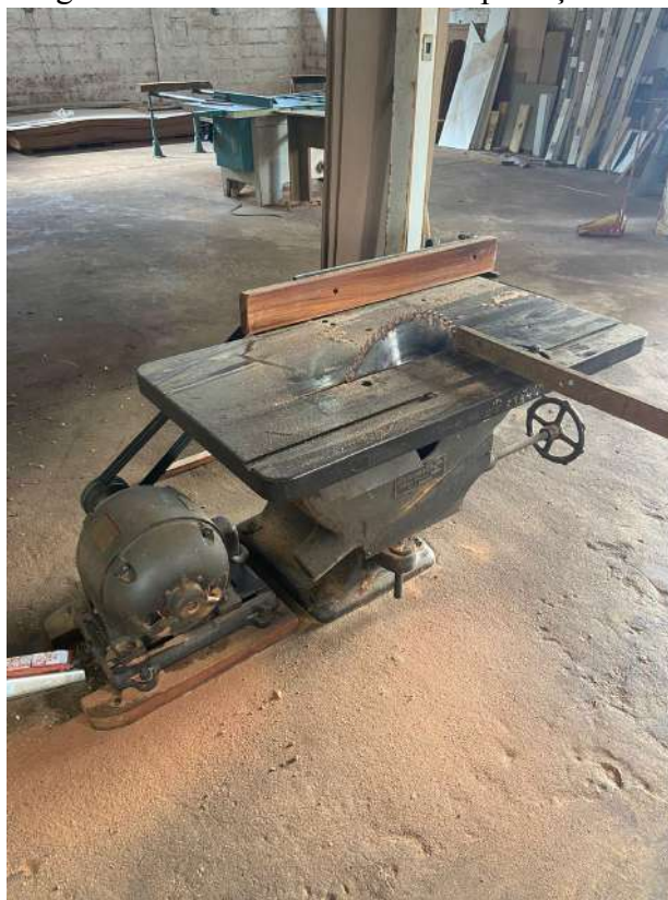
Figura 8: Serra de Bancada sem proteção.
