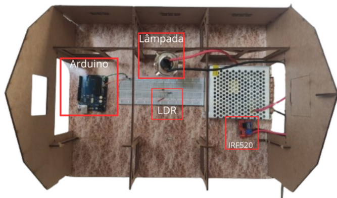
Figura 4.10 – Celeiro com equipamentos montados vista superior
