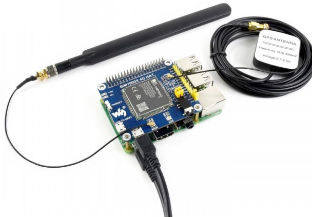
Figura 4 - Módulo de expansão com conectividade 4G e suporte a GPS.
