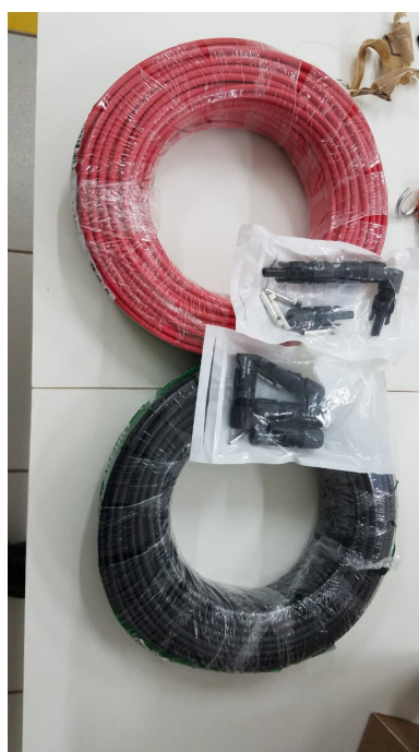
Figura 6.3 – Cabos com blindagem e conectores
