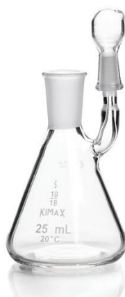
Figura 13- Picnômetro de 25 ml
