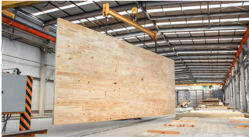
Figura 2 – Painel em CLT sendo movimentado na indústria
