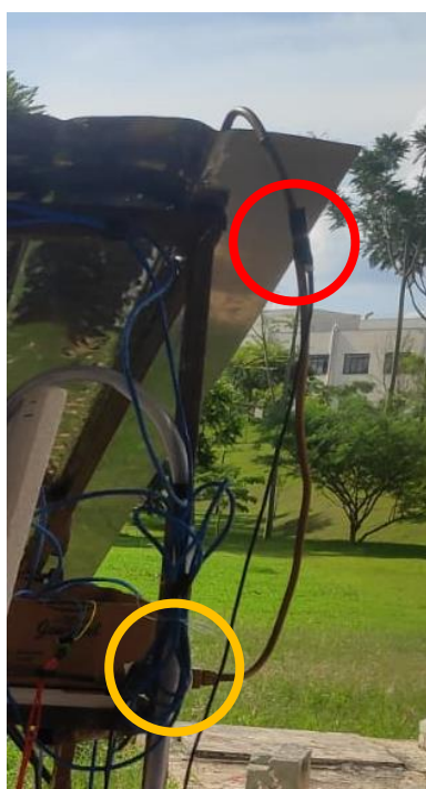
Figura 32 - Ponto de medição de temperatura (Vermelho) e válvula de expansão (Amarelo)
