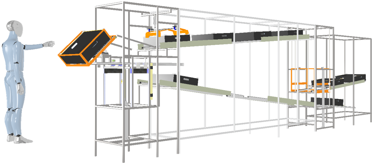
Figura 11. Projeto final do flow rack .
