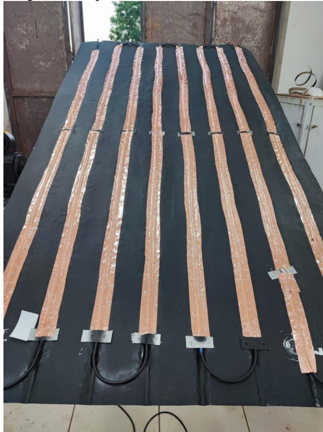
Figura 3.3 Evaporador/Coletor solar com fitas de cobre
