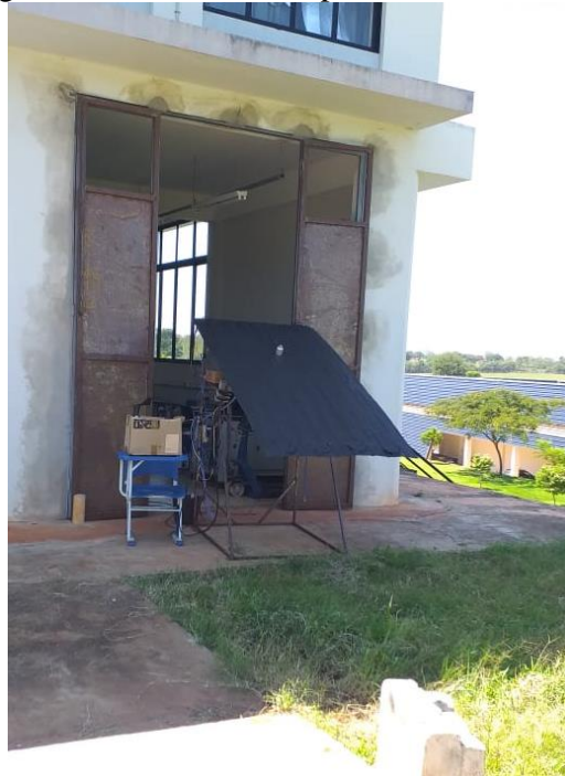
Figura 3.17 Bomba de calor posicionada na sombra.
