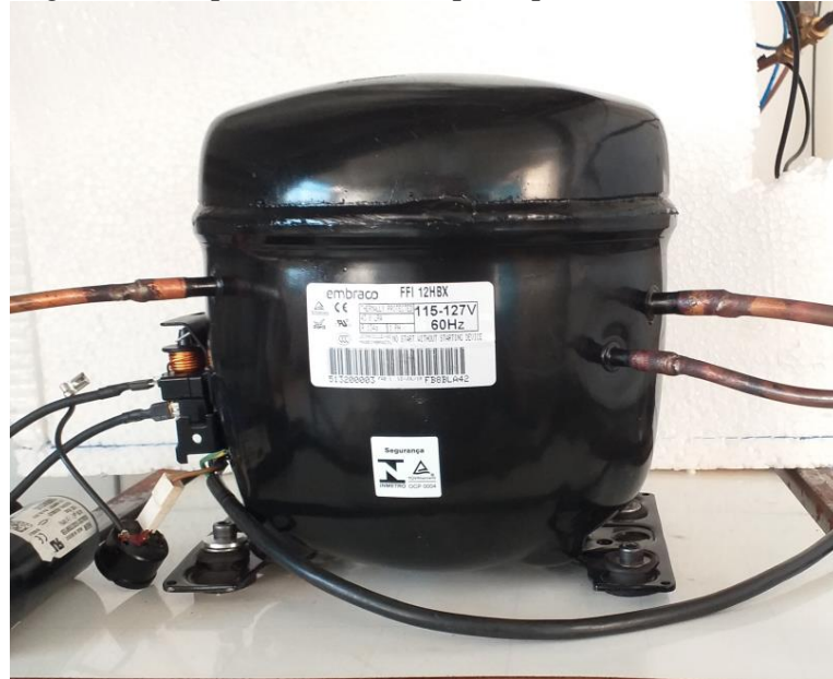
Figura 2.4 Compressor utilizado no protótipo embraco FFI 12HBX
