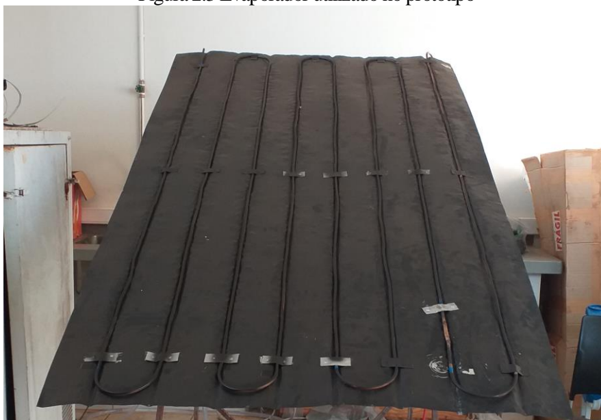
Figura 2.3 Evaporador utilizado no protótipo
