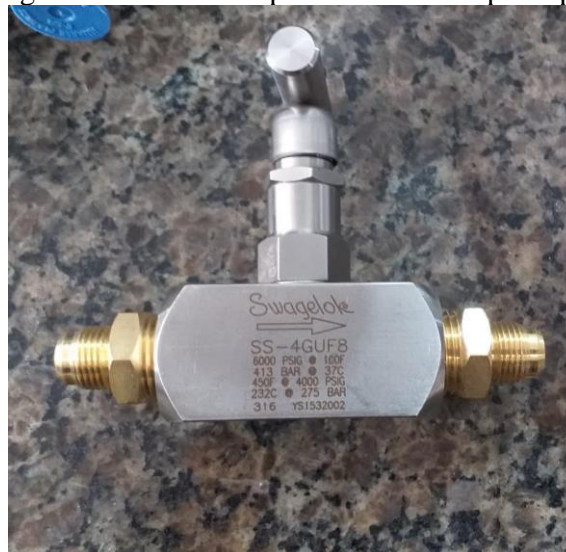
Figura 2.6 Válvula de expansão utilizada no protótipo
