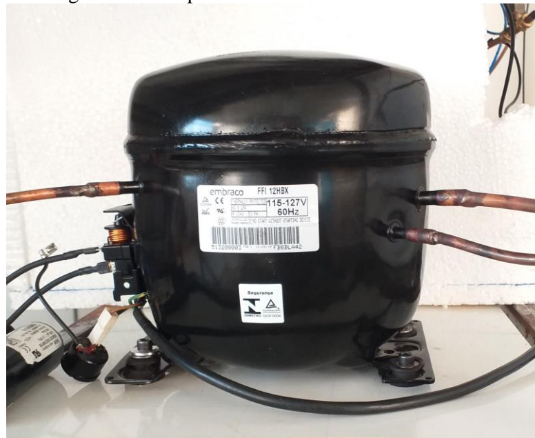
Figura 3.5 – Compressor hermético Embraco FFI 12HBX
