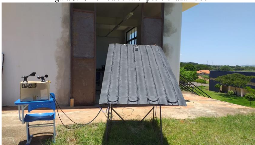
Figura 3.18 Bomba de calor posicionada no sol.
