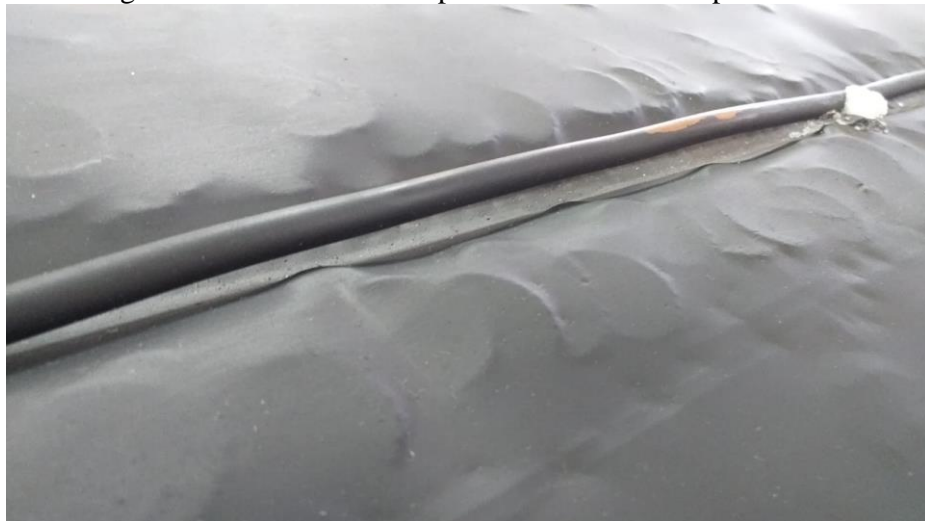
Figura 3.2 Tubo de cobre com pouco contato com a chapa metálica
