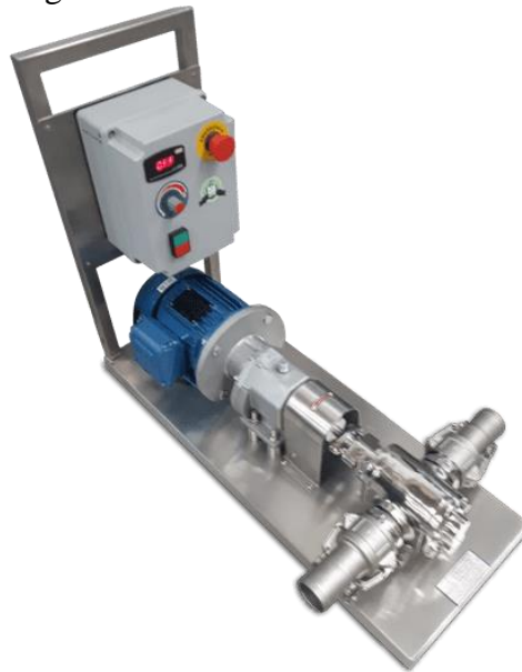
Figura 12 - Bomba de transferência.
