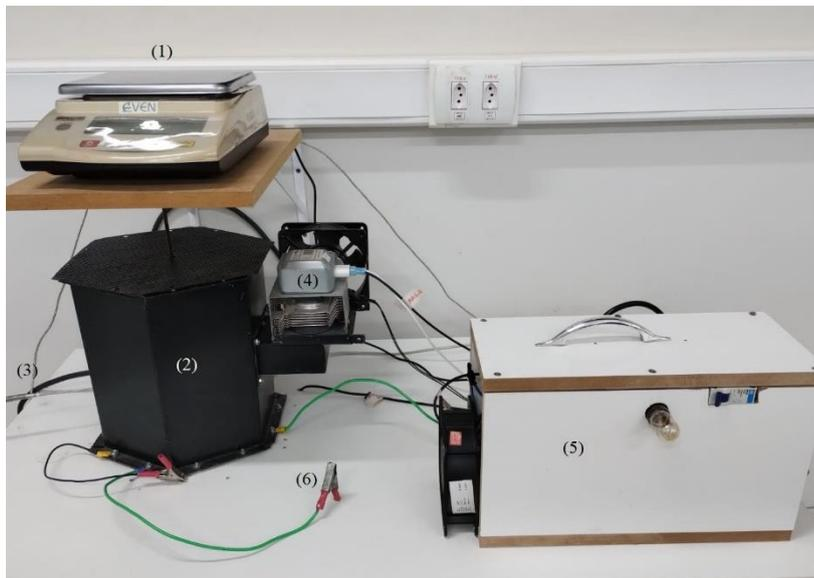
Legenda: Balança Digital Even (1), modelo BL-6200AS-BI, cavidade (2), termopar (3), magnetron (4), sistema elétrico (5), cabos de aterramento (6).
