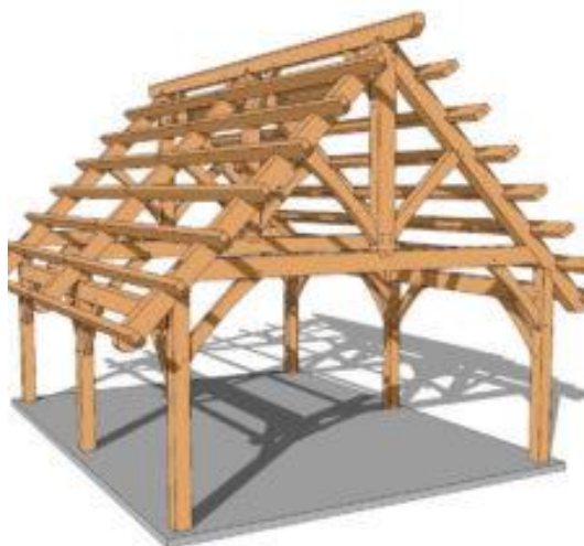
Figura 5 - Sistema construtivo porticado de madeira (Post & Beam).
