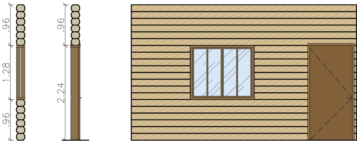
Figura 41 - Instalação de esquadrias em paredes de log home.
