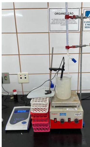
Figura 6 – Aparato montado para a determinação do volume da solução de cal hidratada necessário para correção do pH do efluente industrial em estudo para valor de 6,5.
