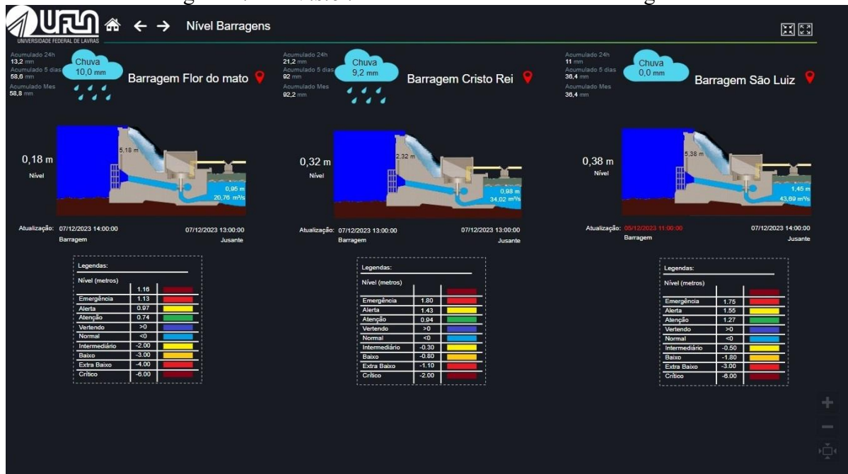
Figura 27 - PI Vision – Tela Monitoramento de Barragens.
