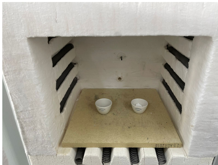
Figura 6: Amostras em início de tratamento térmico no forno utilizado
