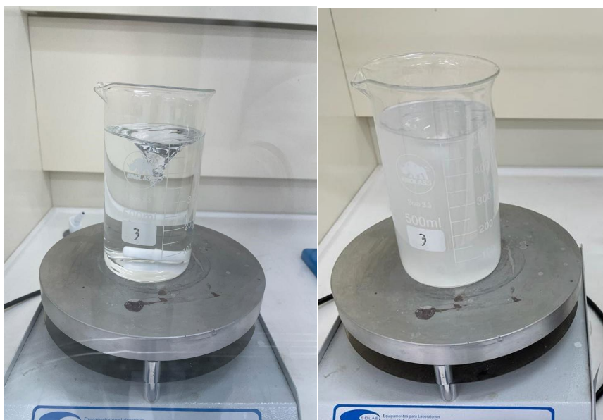
Figura 12: Solução com precursor TEOS antes e depois de 24 horas de agitação, respectivamente.
