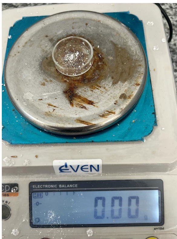
Figura 18: Material proveniente das CCA obtido após calcinação.
