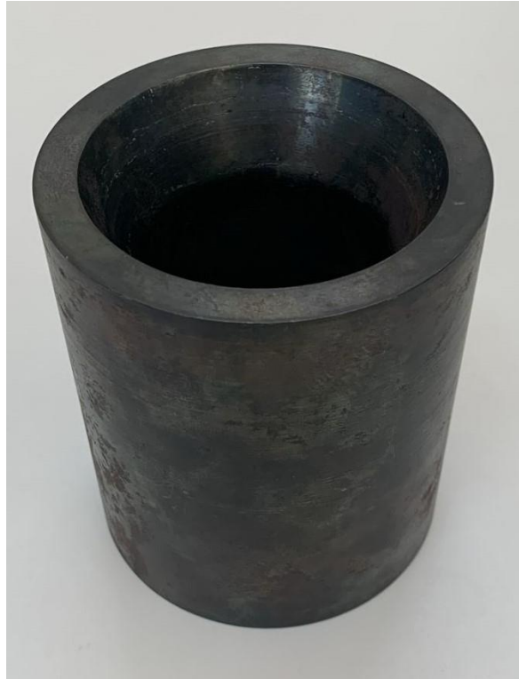
Figura 3.3 - Molde metálico utilizado, em aço SAE 1020.
