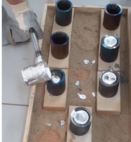
Figura 3.4 - Vazamento da liga A356 fundida.
