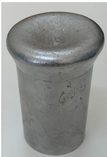
Figura 3.7 - Exemplo de corpo de prova fabricado sem adição de ferro.
