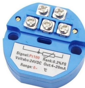
Figura 7 – Exemplo de um conversor capaz de receber sinais elétricos de um termorresistência do tipo PT100 e condicioná-los para o padrão 4..20mA.
