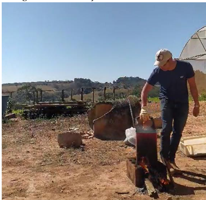
Figura 1. Carbonização da casca de café manualmente.
