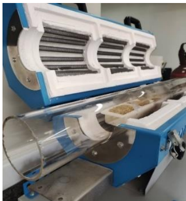
Figura 9. Forno túnel do modelo EDG/série FT-HI, com as amostras de biomassa de cana-de-açúcar.
