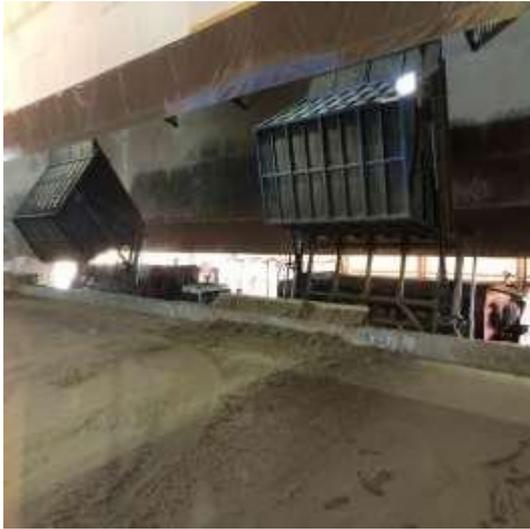
Figura 3 - Descarregamento automatizado de Batch Box
