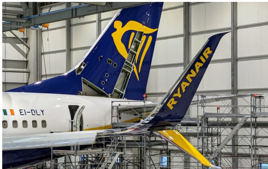
Figura 6.5 – Scimitar Winglet do Boeing 737-800.
