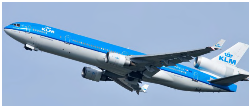
Figura 7.3 – Scimitar Winglet do avião McDonnell Douglas MD-11.
