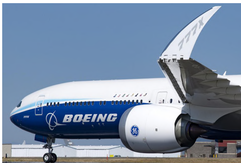
Figura 7.2 – Asa dobrável do Boeing 777X.
