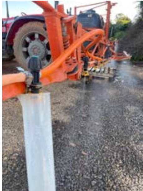
Figura 4 - Processo de captação da calda usando recipientes graduados para calibração do pulverizador.
