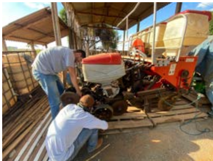
Figura 19 – Treinamento de regulagem de semeadora adubadora.
