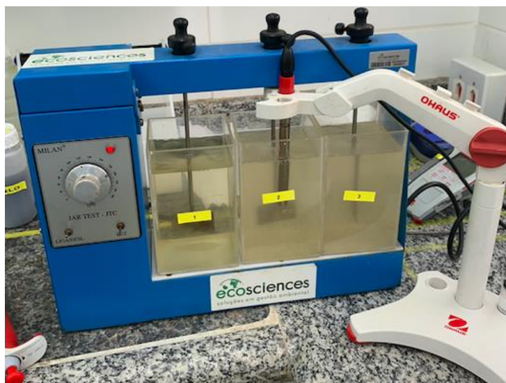
Figura 4 – Demonstração do procedimento de controle de pH conforme adição de solução.
