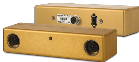
Figura 2.4 – Modelo de câmera de visão estéreo Bumblebee2 da empresa Flir.
