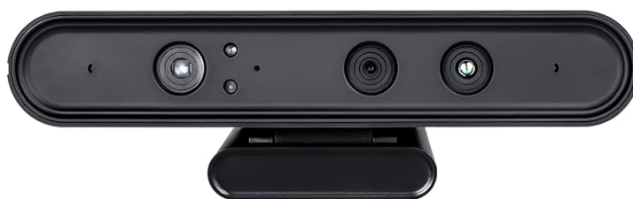
Figura 2.6 – Modelo de câmera RGBD da Orbbec (Atra Pro).
