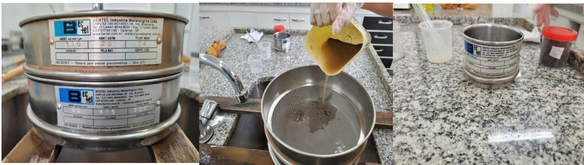
Figura 1: Primeira etapa do método de Gerdemann e Nicolson (1963) para extração de esporos de FMAs. A: conjunto de peneiras de malha 0,071 e 0,020 respectivamente. B: Sobrenadante sendo vertido no conjunto de peneiras. C: Peneira menor de malha 0,020 mm.
