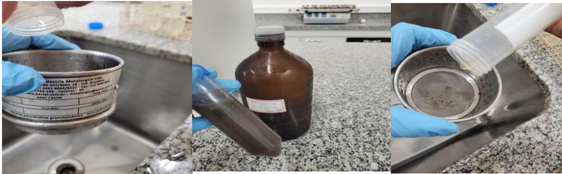
Figura 2: Segunda etapa do método de Gerdemann e Nicolson (1963) para extração de esporos de FMAs. A: sobrenadante após a primeira etapa de centrifugação sendo vertido; B: adição de sacarose 50% no tubo de centrifugação após homogeneização; C: Sobrenadante contendo a sacarose sendo vertido em peneira para ser enxaguado após a centrifugação.
