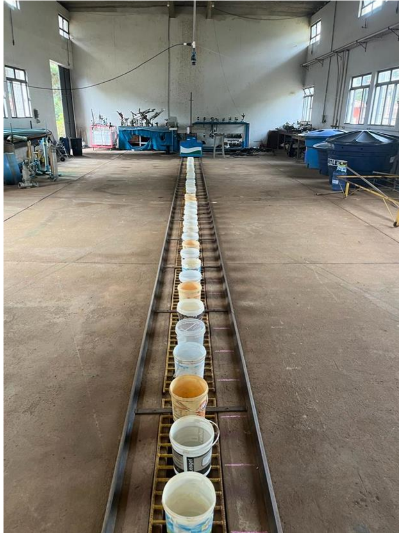
Figura 6 – Distribuição dos coletores para realização dos experimentos.
