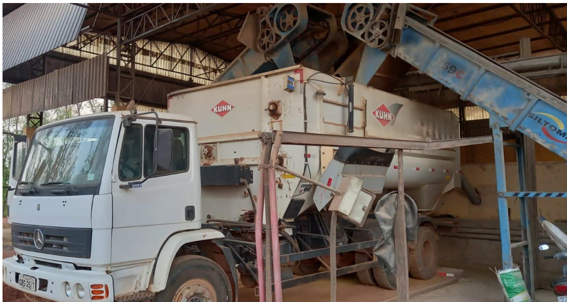
Figura 16. Caminhão Mercedes Benz modelo 2729 série Atron 290 CV com vagão misturador Kuhn modelo RC série 200
