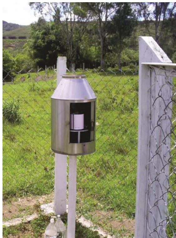
Figura 2. Pluviógrafo do posto de observação em Bom Jardim de Minas, bacia hidrográfica do Rio Grande.
