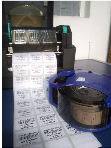
Figura 14 – Processo de impressão de etiquetas.
