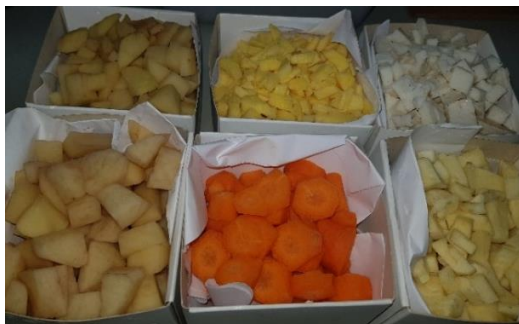
Figura 3 – Detalhe de amostras in natura acondicionadas em recipiente de papel para posteriormente serem levados a estufa.
