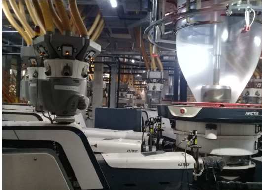
Figura 4 – Extrusora de filme tubular
