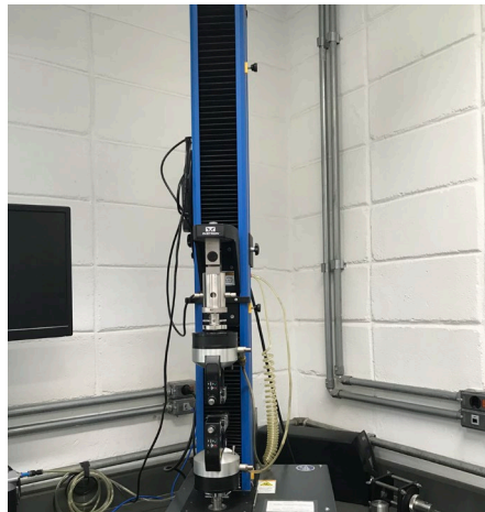
Figura 9 – Equipamento INSTRON para análise de módulo, alongamento e tração
