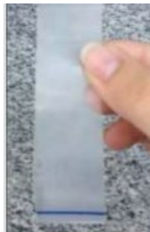
Figura 10 – Corpo de prova para análise de módulo, alongamento e tração
