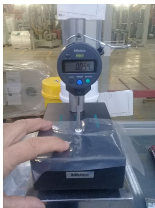
Figura 5 – Equipamento de análise de espessura
