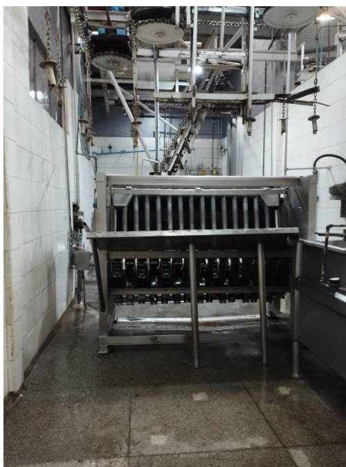
Figura 17 – Depiladeira do frigorífico utilizada no abate de suínos.
