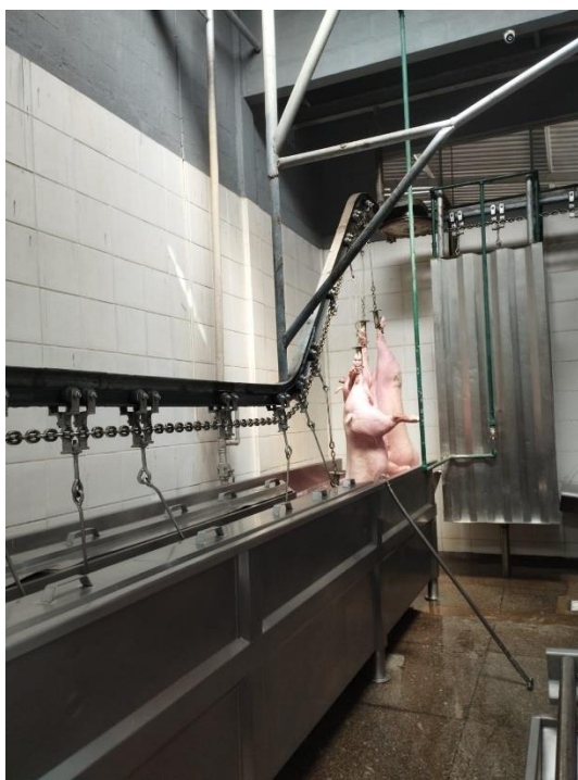
Figura 16- Tanque de escaldagem utilizado no abate de suínos.
