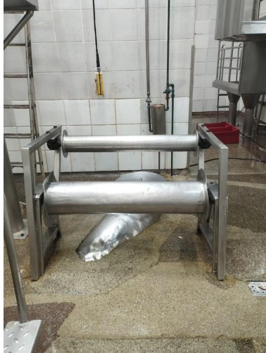
Figura 5- Rolete utilizado para a retirada do couro da carcaça de bovinos.
