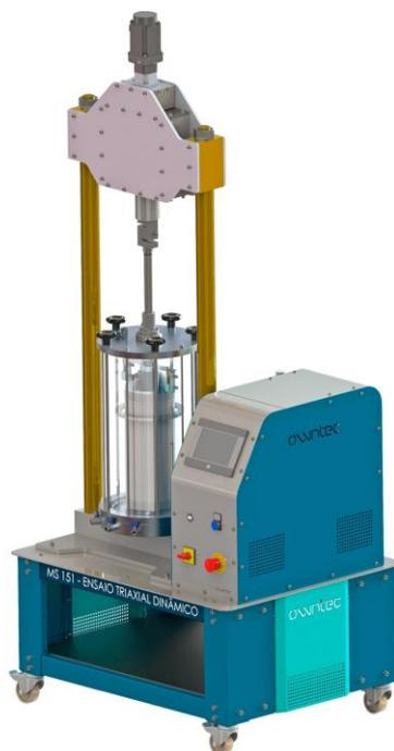
Fonte: Ensaio Triaxial - Modulo de Resiliência. Owntec.
