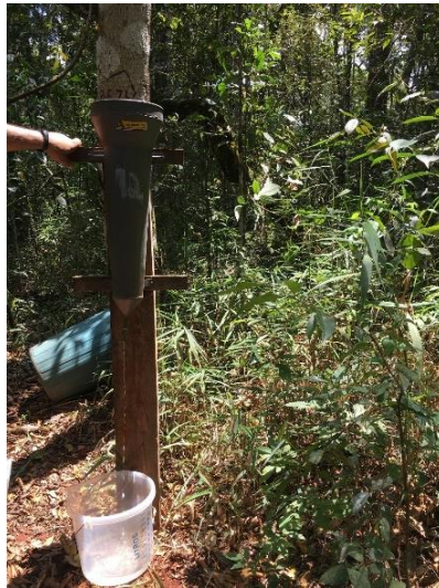
Figura 2 - Pluviômetro instalado no interior da mata
