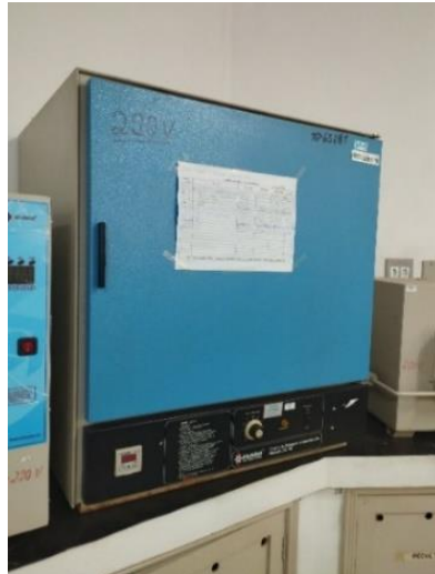
Figura 9 – Estufa utilizada para secagem do solo
