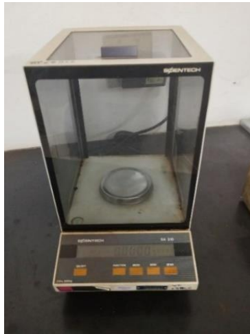
Figura 8 – Balança de alta precisão utilizada para quantificar a massa de solo seco
