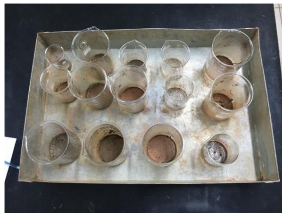
Figura 10 – Amostras de solo após secagem em estufa
