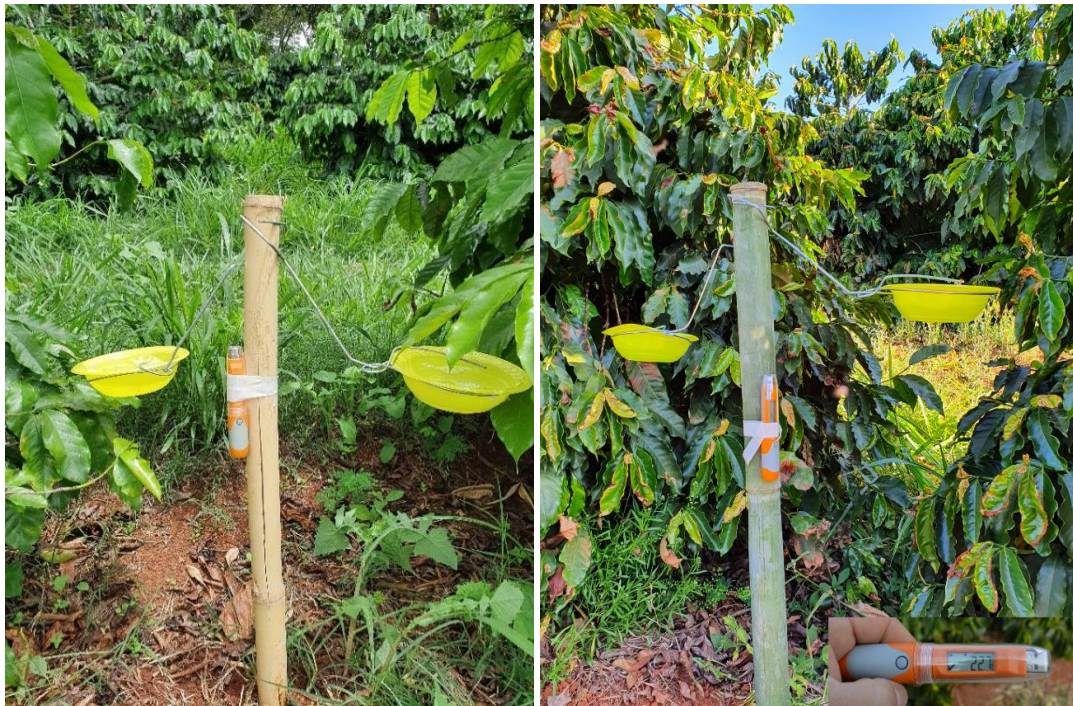
Figura 6 – Armadilhas do tipo pan-trap para coleta de insetos e, no detalhe, um dos dataloggers utilizados para medição de umidade relativa do ar e temperatura. Santo Antônio do Amparo, MG, 2022.
