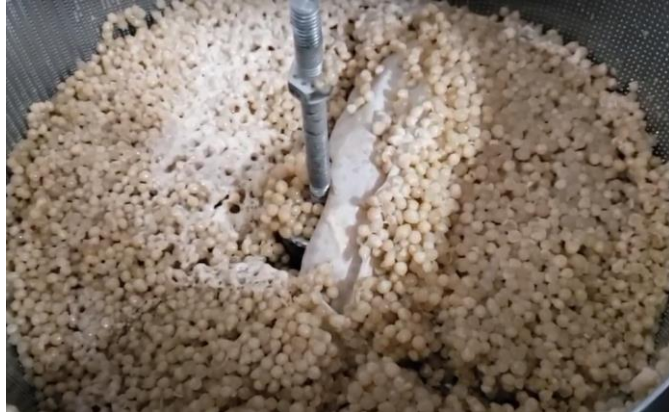
Figura 37 - Leveduras isoladas em microesferas no biorreator.
