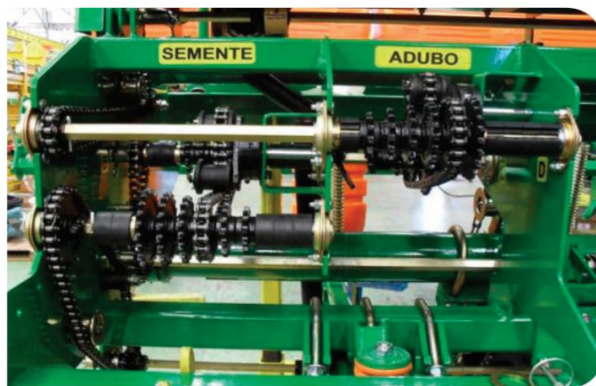
Figura 12 - Sistema de transmissão de uma semeadora - adubadora.
