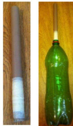
2. Recorte um retângulo de cartolina de 8 cm de largura e 20 cm de altura. Enrole-o ao redor do tubo de pvc para fazer um tubo de papelão de 2 cm de diâmetro e 20 cm de altura. Mantendo o tubo de pvc dentro do tubo de cartolina passe ao redor deste, anéis de fita adesiva para fixar o tubo de cartolina; depois coloque fita adesiva ao longo do comprimento do tubo de cartolina sobre a emenda da cartolina.
